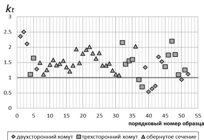
Рис. 14. Отношение опытной несущей способности по наклонному сечению к расчетной по методике ACI 440.2R-08 [7]
