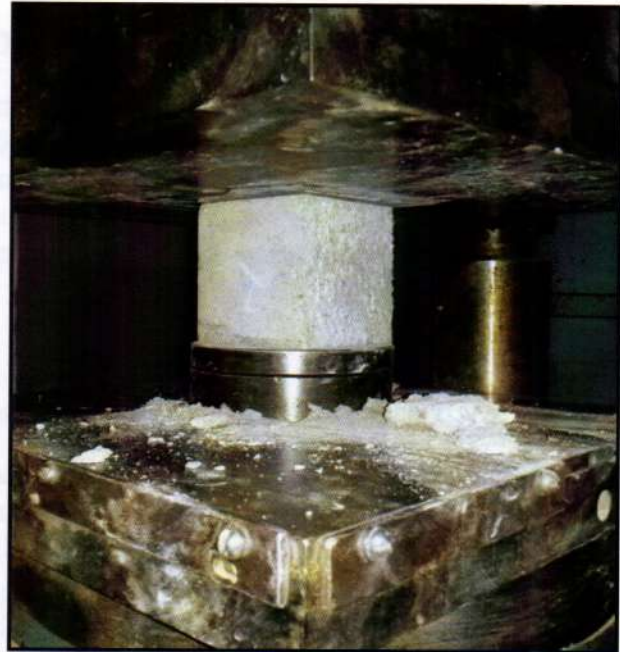
Şəkil 2. Məsaməli beton nümunələrinin sıxılmada möhkəmliyə sınağı
