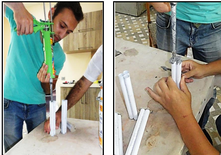
Şəkil 2. İki komponentli yapışdırıcı tərkiblərin sınaq nümunələrinin hazırlanması.
