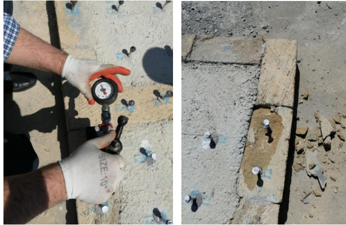
Şəkil 7. Armatür millərinin mişardaşında qopma sınaqlarının aparılması və anker düyünün dağılma xarakteri
