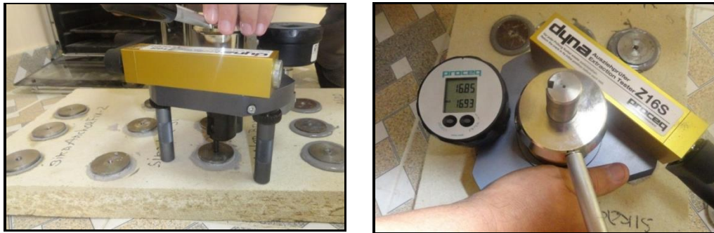
Şəkil 5. Əhəngdaşı üzərinə yapışdırılmış nümunələrin qopma müqavimətinin qiymətləndirilməsi
