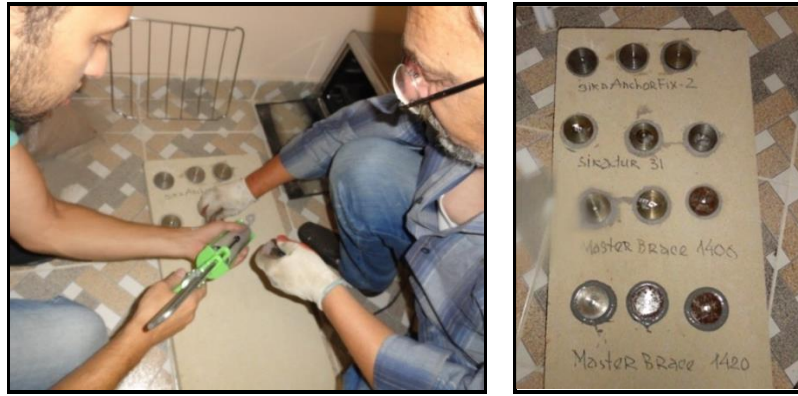
Şəkil 4. İki komponentli yapışdırıcı tərkiblərin əhəngdaşı səthi ilə ilişənlik göstəricilərinin sınaq nümunələri
