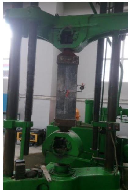
Şəkil 4.2. Karbolifli sarılı beton nümunəsinin GPM-2A markalı dartılma pressində sınaq görünüşü
