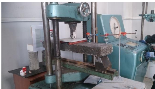
şəkil 5.2. Dartılma zonasına karbolifli laminat yapışdırılmış beton nümunəsinin sınaq şəkl
