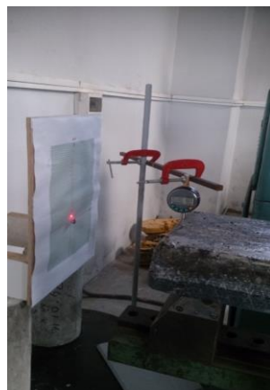
Şəkil 5.4. Əyilmədə dartılma sınağı zamanı dayaqda yaranan dönmə bucağının müşahidəsi
