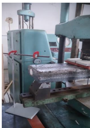
Şəkil 5.4. Əyilmədə dartılma sınağı zamanı dayaqda yaranan dönmə bucağının müşahidəsi
