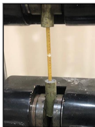
Şəkil 2. Lifli kompozit millərin dartılmaya sınağı.
