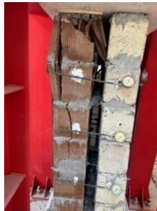
Şəkil 7. Bir qatı keramik daşlardan hörülmüş çevik rabitəli boşluqlu divar nümunələrinin mərkəzi sıxılmada dağılması
