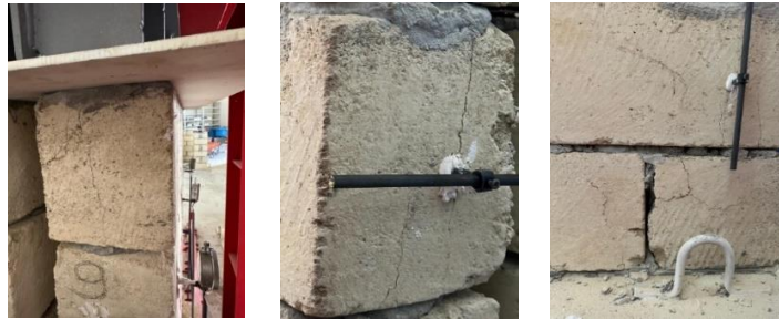
Şəkil 6. Çevik rabitəli boşluqlu divar nümunələrinin mərkəzi sıxılmada dağılması
