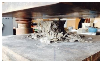
Şəkil 5. Laboratoriya hidravlik presində nümunələrin sınağı.
