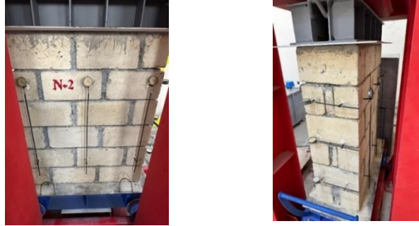
Şəkil 2. Sərt rabitəli boşluqlu divar nümunələrinin sınaqları a) mərkəzi sıxılma b) mərkəzdən xaric sıxılma
