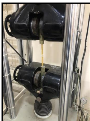
Şəkil 2. Lifli kompozit millərin dartılmaya sınağı.
