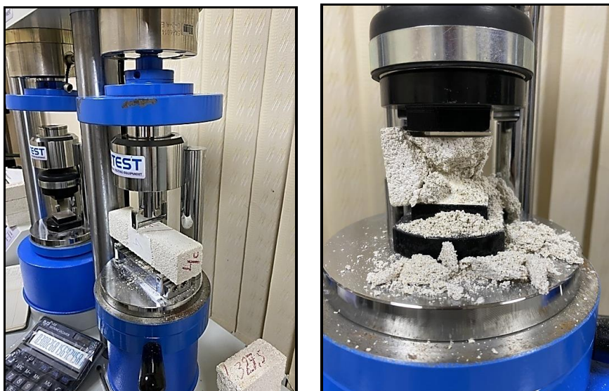
Şəkil 2. İşlənmiş süni üzlük tərkiblərinin nümunələrinin əyilmə zamanı dartılmaya və sıxılmaya sınaqlarının aparılması.
