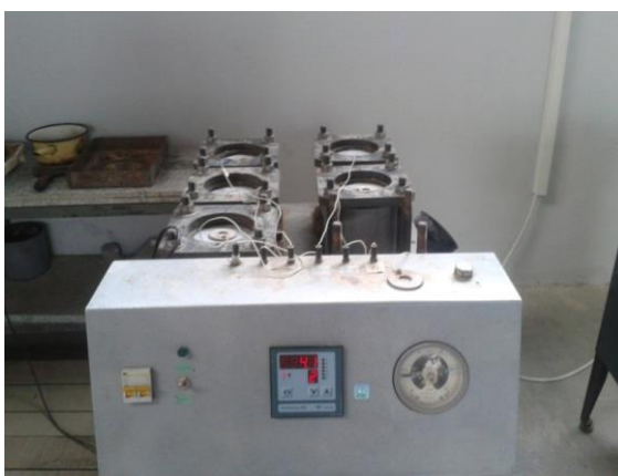
Şəkil 5. Beton silindr nümunələrin su keçirməməzlik sınağının şəkli
