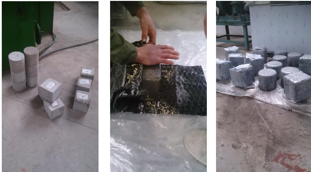
Şəkil 2. Beton nümunələrin karboliflə sarınması
