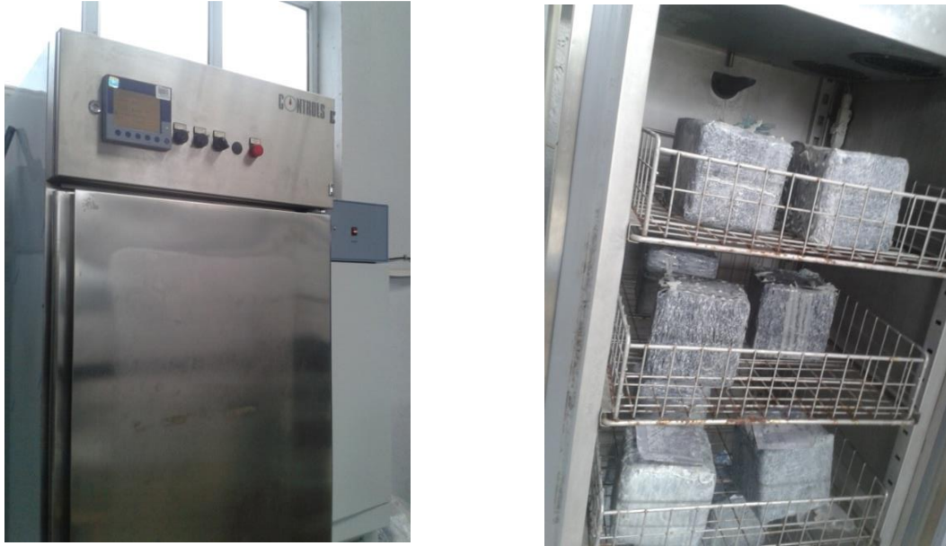
Şəkil 7. Nümunələrin CONTROL 10-D 1429 refrejeratorda yerləşməsi.
