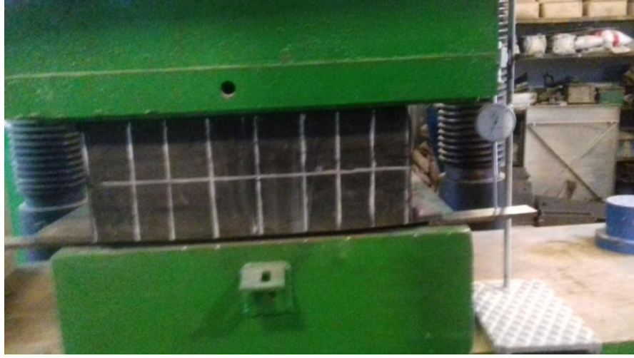
Şəkil 2. Elastomerin sıxılma sınağının şəkli
