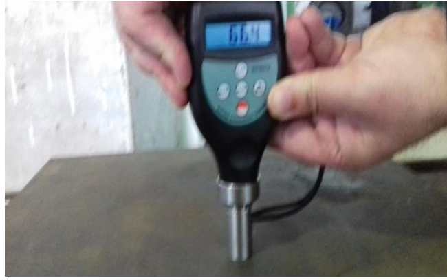
Şəkil 6. Bərklik ölçmə sınağı.
