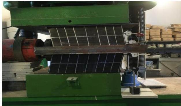
Şəkil 5. Sıxılma zamanı yandan qüvvə vermə sınağının şəkli.
