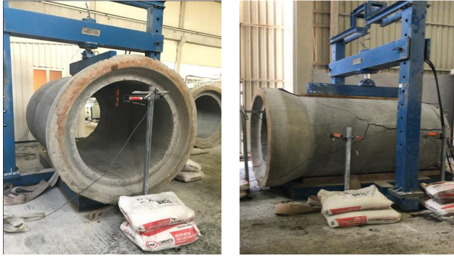
Şəkil 5. Boruların sınağı
