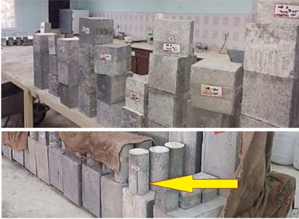
Şekil 1. Deney için hazırlanmış silindir ve küp numuneler
