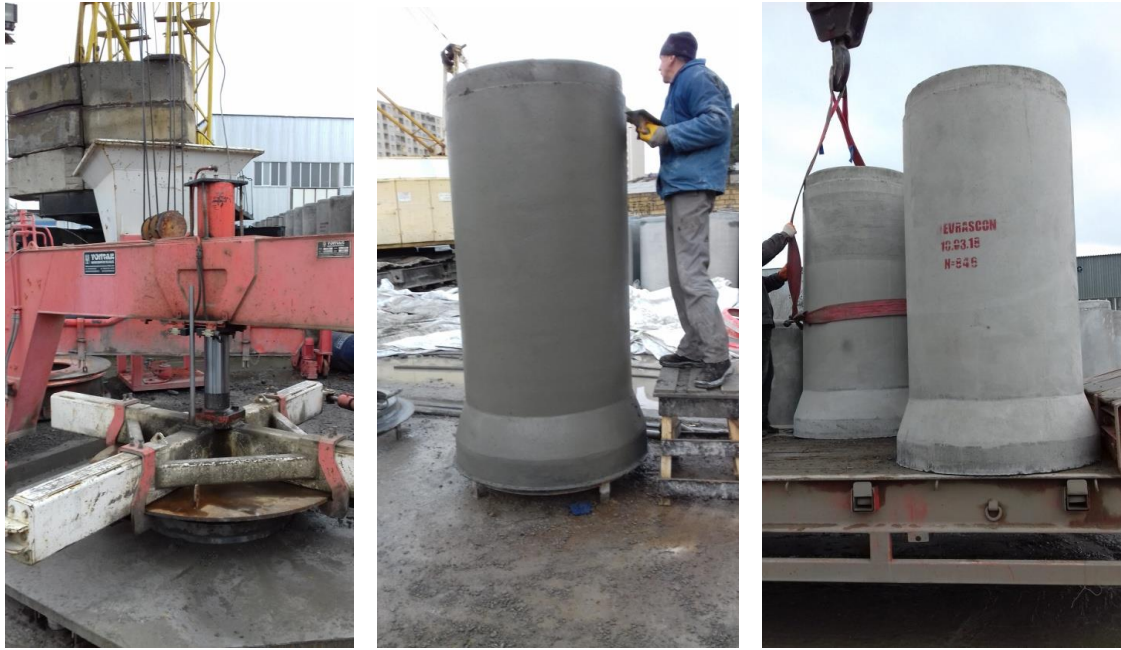
Şəkil 1. Evraskon ASC şirkətinin zavodunda hazırlanan dəmir-beton kanalizasiya boruları
