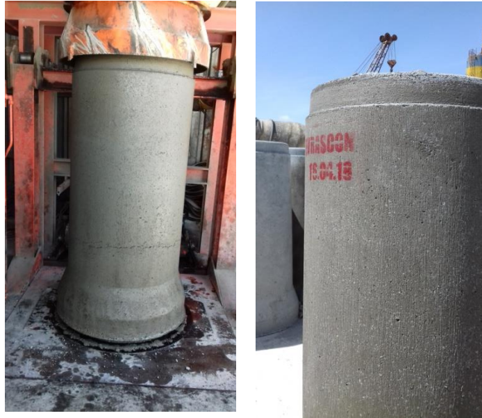
Şəkil 5. Evrascon ASC zavodunda vibropressləmə ilə fibrobeton borusunun cihazdan çıxmasının görüntüsü
